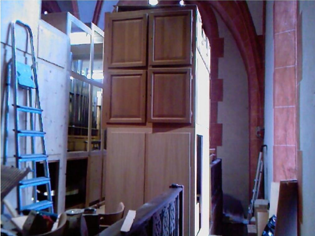
Das ehemalige Rückpositiv mit neuem Unterbau in dem jetzt Motor und Balg untergebracht sind.
