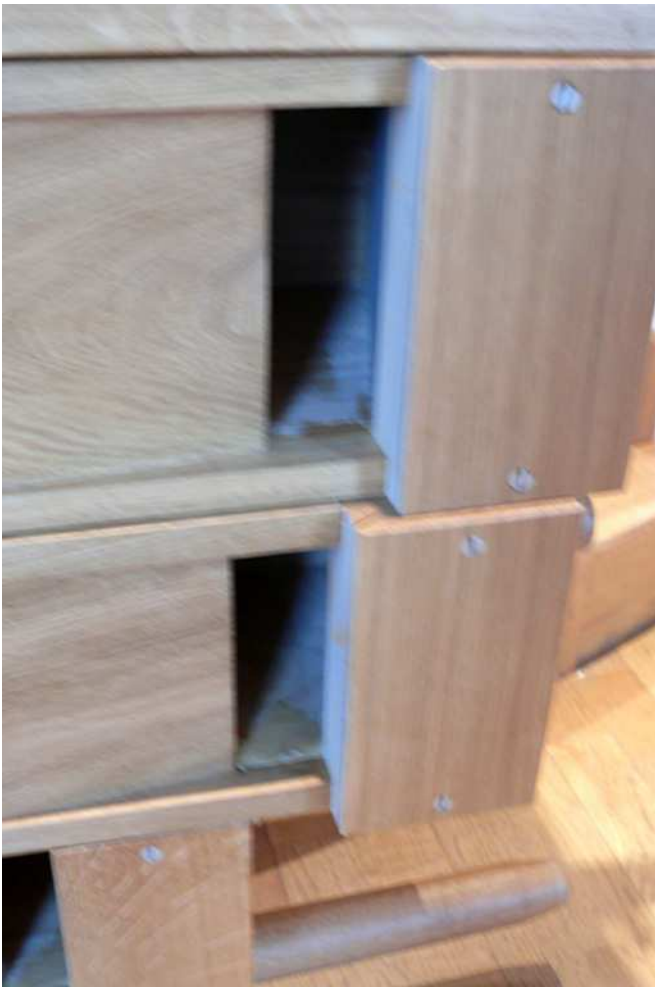
Stark verstaubte Kernspalten der Holzgedackte
