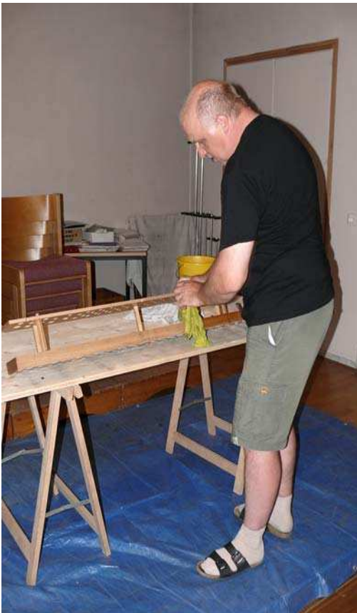
Herr Plenz reinigt die Pfeifenstöcke mit feuchtem Tuch und die Pfeifen mit Pinsel und Flaschenputzer
