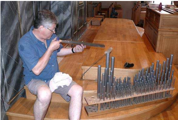
Herr Raab reinigt durch Blasen, mit dem Flaschenputzer und einem Lappen
