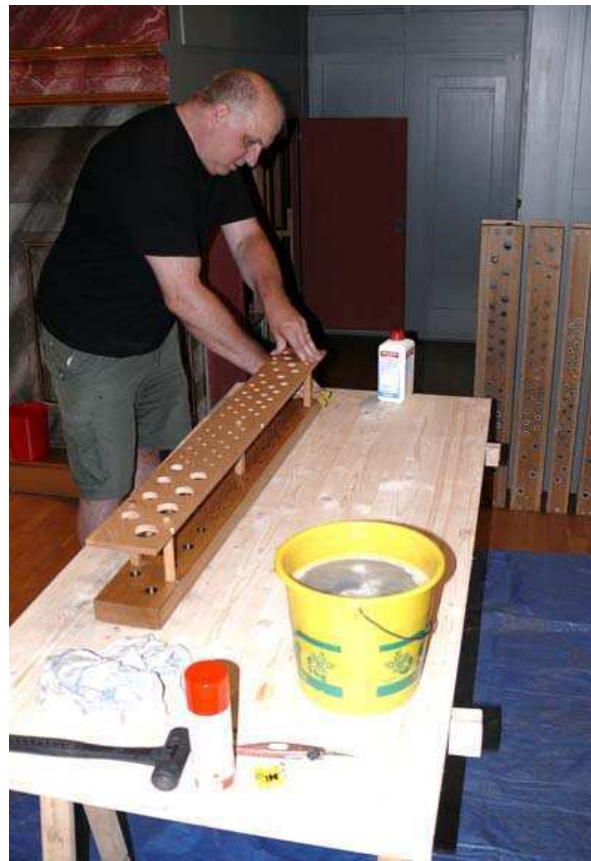
Herr Plenz reinigt die Pfeifenstöcke mit feuchtem Tuch und die Pfeifen mit Pinsel und Flaschenputzer
