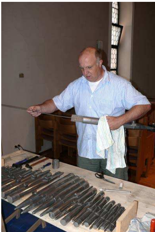
Herr Plenz reinigt die Pfeifenstöcke mit feuchtem Tuch und die Pfeifen mit Pinsel und Flaschenputzer
